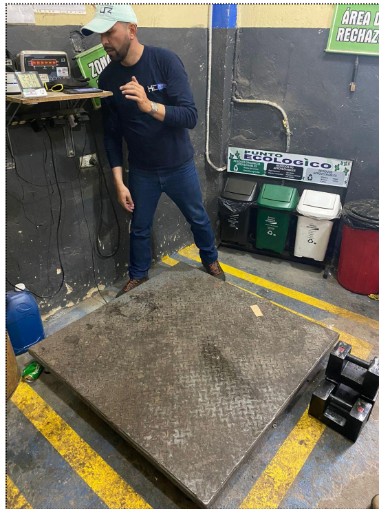
Gráfico 12. Calibración de básculas de la Asociación RECICONDOR por parte de la empresa METLAB.
